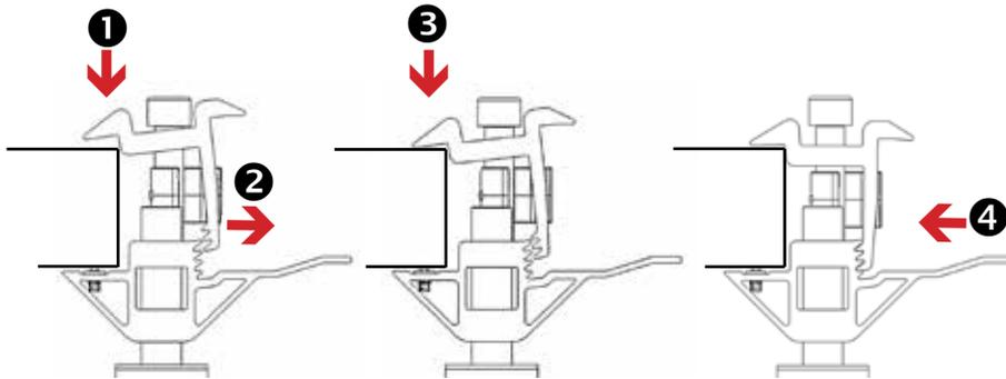
**ADJUST MICRORAIL CAP DOWN TO ENGAGE WITH MODULE:**
