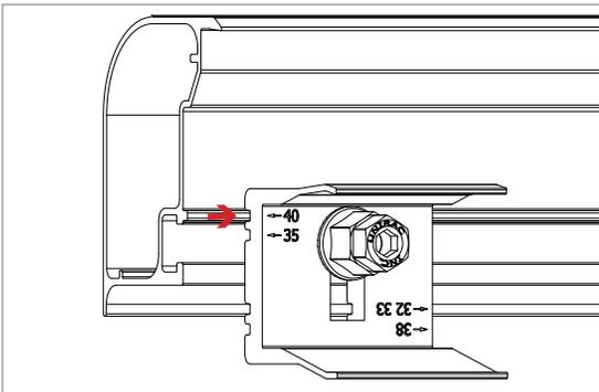
**POSITION MODULE CLIPS ACCORDING TO MODULE THICKNESS:**
