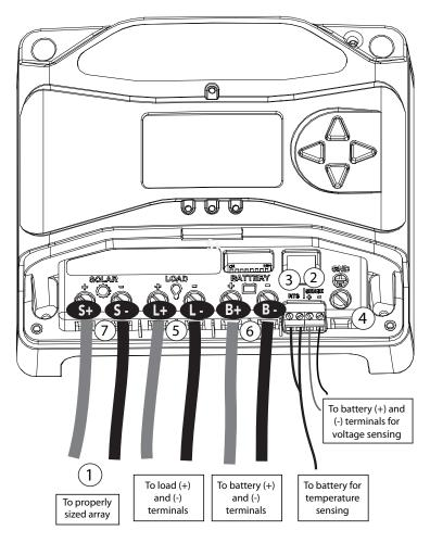
Figure 3-3. Wiring the PS-MPPT
